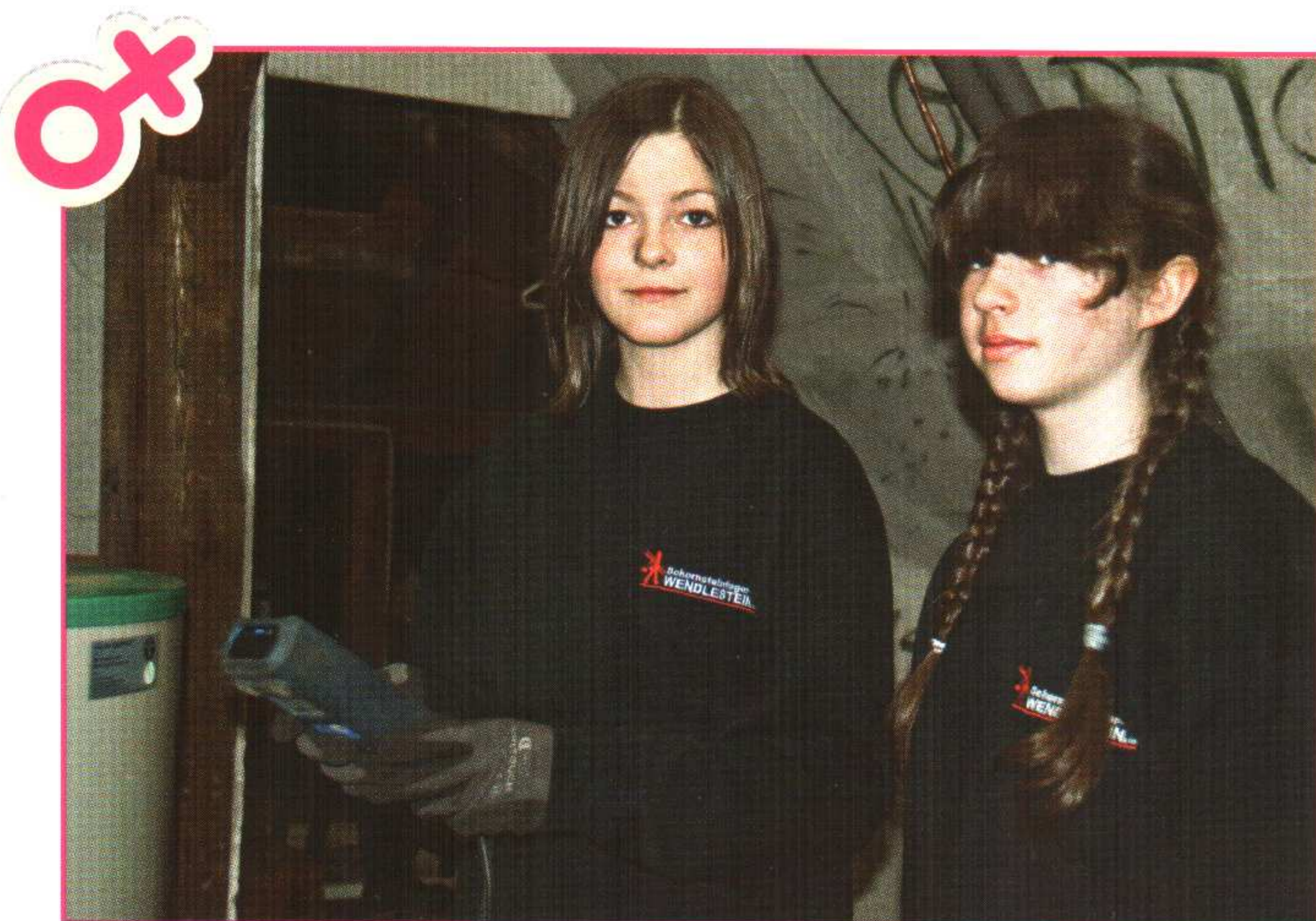
Bei der Messtechnik zeigt sich das Schornsteinfegerhandwerk von seiner modernen Seite – hier Messung nach der 1. BImSchV.
